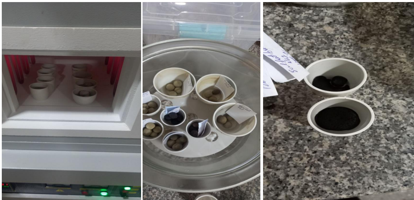
2- rasm. Klinkerlarni pishirib lava holatiga kelish jarayonlari.
