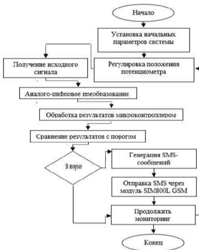
4-рис. Алгоритм формирования управляющих сигналов системы
