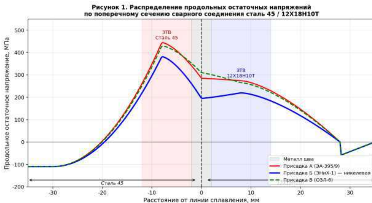
Рисунок 1. Распределение продольных остаточных напряжений по поперечному сечению сварного соединения сталь 45 / 12X18H10T для трёх присадочных материалов
